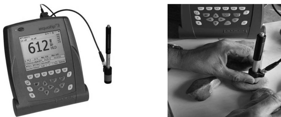
Figura 4.1: Dispositivo de medición de dureza de la cuarcita: Equotip.
