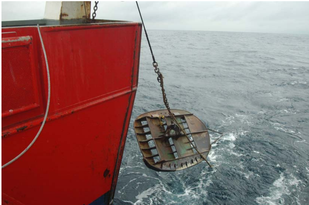
Figura 3.3: Porta convencional para a pesca de arrastre demersal.
