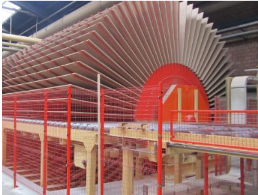
Figura 1.2: Sistema de enfriamiento de los tableros de MDF (Fuente: Cooling system for wood panels (2022) Schermesser Handling Systems https://www.schermesser.fr/en/cooling-system-for-wood-panels/ , Accedido 7 de julio de 2024).
