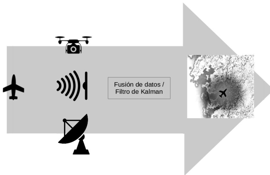
Figura 2.4: Distintos sensores detectan un UAV y realizan mediciones por separado. Luego, un módulo de fusión de datos utiliza un filtro de Kalman para lograr una única medición más precisa y exacta, a partir de las anteriores.
