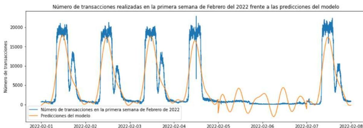
Figura 5.16: Comparación gráfica del número de operaciones real frente a las predicciones obtenidas con el modelo Prophet con dos componentes estacionales semanales. Se representan los valores en la primera semana de febrero de 2022.
