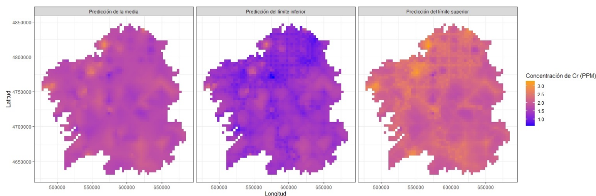
Figura A.3: Mapas de predicción de la concentración de Cr. A la izquierda la concentración media, en el centro el límite inferior (cuantil 2,5 de los valores ajustados) y a la derecha el límite superior (cuantil 97,5 de los valores ajustados).
