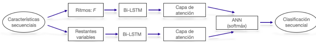
Diagrama 2.5: Arquitectura da rede neuronal que conforma o clasificador secuencial, baseándonos na concatenación de dúas capas de atención, co uso de redes con esquema Bi-LSTM.
